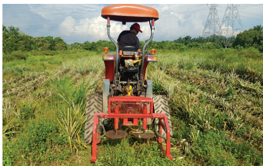
Gambar 3. Gabungan traktor pelepasan tinggi sangkutan pada mesin pencantas pokok nenas yang boleh memasuki ladang nenas di antara baris
