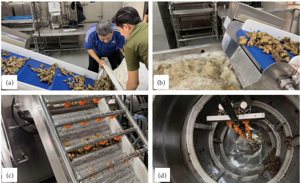
Gambar 3. (a) Rizom halia segar yang diselaputi tanah diletakkan di atas incline conveyor, (b) Halia dari incline conveyor dimasukkan ke dalam mesin precleaning, (c) Halia yang telah melalui prapembersihan di dalam precleaning machine dimasukkan dalam mesin drum washer melalui incline conveyor dan (d) Halia dibasuh dalam mesin drum washer
