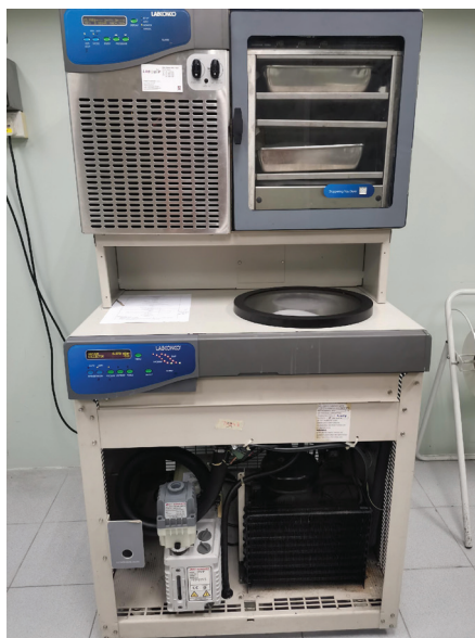
Gambar 4. 'Freeze dryer' yang digunakan daripada jenama Labconco
