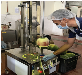
(a) Tembikai dibuang kulit menggunakan mesin pengupas kulit buah tembikai
