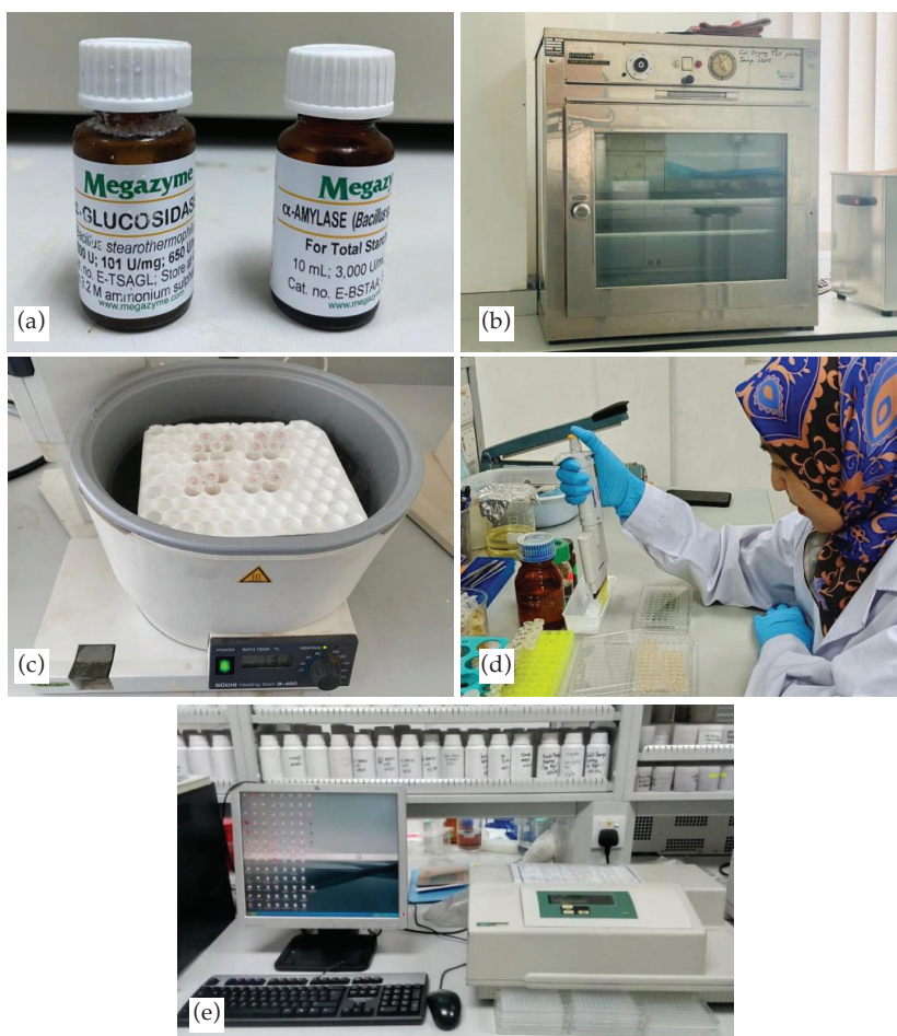
Gambar 2. (a) Enzim \alpha -glukosidase dan \alpha -amilase, (b) Pengeraman (inkubasi) sampel menggunakan inkubator (c) Pemanasan sampel menggunakan water bath, (d) Analisis perencatan enzim dan (e) Keputusan analisis diukur menggunakan pembaca plat mikro
