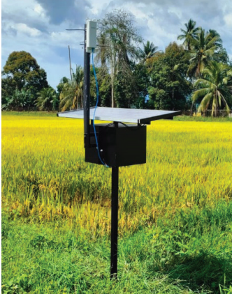
Gambar 2. Penghala Internet tanpa wayar berkuasa solar di lapangan
