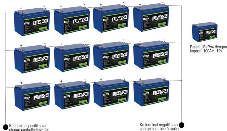
Gambar rajah 2. Contoh sambungan litar bagi bateri berkapasiti 100 AH 12 v untuk mendapatkan kapasiti elektrik harian sebanyak 13.6 kWh
