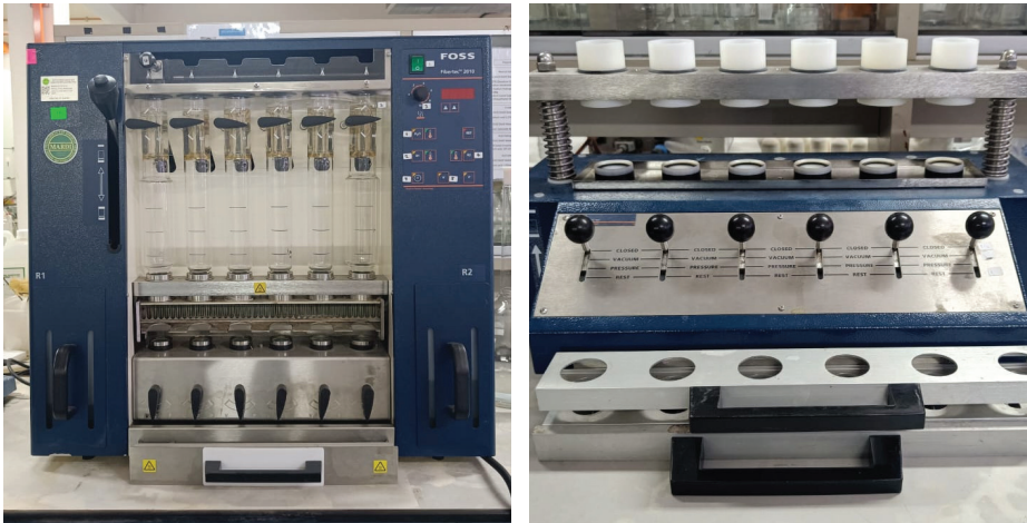
Gambar 4. Mesin Fibertec yang digunakan untuk analisa serat kasar (CF), Serat Detergen Neutral (NDF), Serat Detergen Asid (ADF) dan Serat Detergen Asid (ADL)
