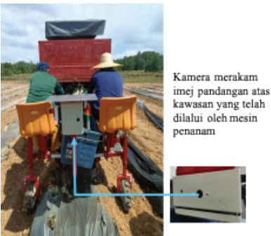
Gambar 5. Sistem pengesanan kualiti penapakan sulur nanas yang dipasang di belakang mesin penanam sulur nanas
