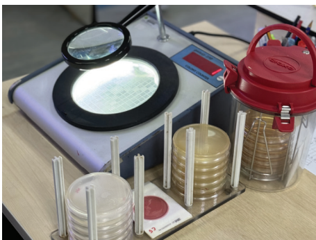
Gambar 3. Keputusan mikrobiologi analog keju dibaca melalui alat penghitung koloni
