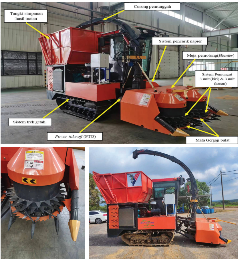
Gambar 1. Mesin penuai napier yang telah dibangunkan
