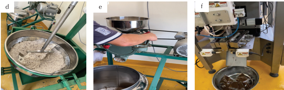
Gambar 1. Sistem mekanisasi pemrosesan kerisik kelapa yang terdiri daripada (a) Mesin patik, (b) Mesin parut, (c) Mesin pengering, (d) Mesin penggoreng, (e) Mesin pengisar dan (f) Mesin pembungkus
