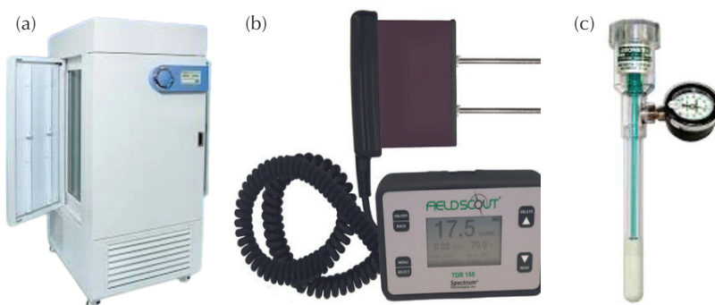
Gambar 1.(a) Kebuk fitotron digunakan untuk simulasi suhu tinggi terhadap sampel tanaman padi, (b) Alat meter kelembapan tanah bagi aruhan kemarau dan (c) Tensiometer untuk penentuan tekanan air dalam tanah semasa tegasan air dikenakan kepada sampel tanaman padi
