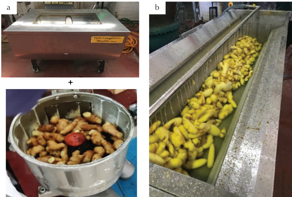
Gambar 1. Mesin pengupasan yang boleh digunakan untuk mengupas halia – kaedah (a) gabungan mesin pembasuh sayuran (vegetable washer) dan pengupas jenis batu (stone peeler) dan kaedah (b) mesin pengupas berus guling (roller brush peeler)
