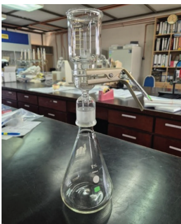
Gambar 1. Radas kaca untuk penapisan sampel air peringkat pertama
