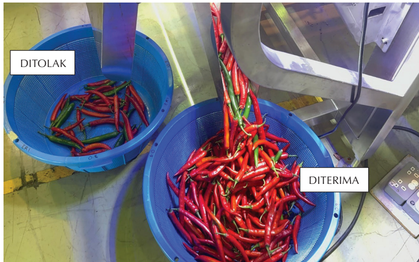
Gambar 4. Penggredan dan penyisihan menggunakan mesin RealTech BL30W
