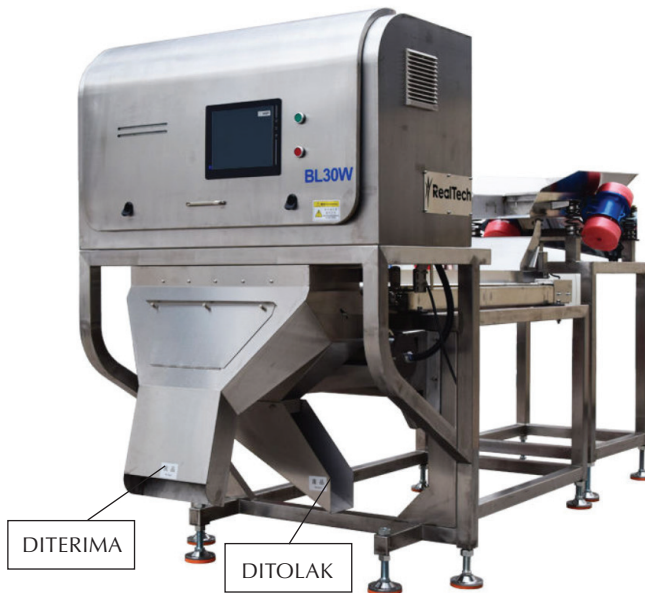
Gambar 1. Mesin penyisih warna komersial RealTech BL30W
