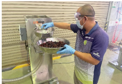
Gambar 2. Operator memasukkan potongan cili kering untuk dikisar menggunakan mesin pengisar
