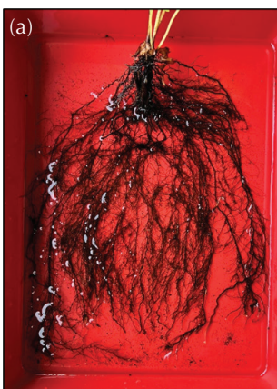
Gambar 4. (a) Sampel akar tanaman paku pakis selepas dicuci, (b) Segmen akar paku pakis yang telah siap dipotong sepanjang 10 cm dan (c) Segmen akar paku pakis yang telah selesai diuji di mana kegagalan berlaku pada bahagian tengah
